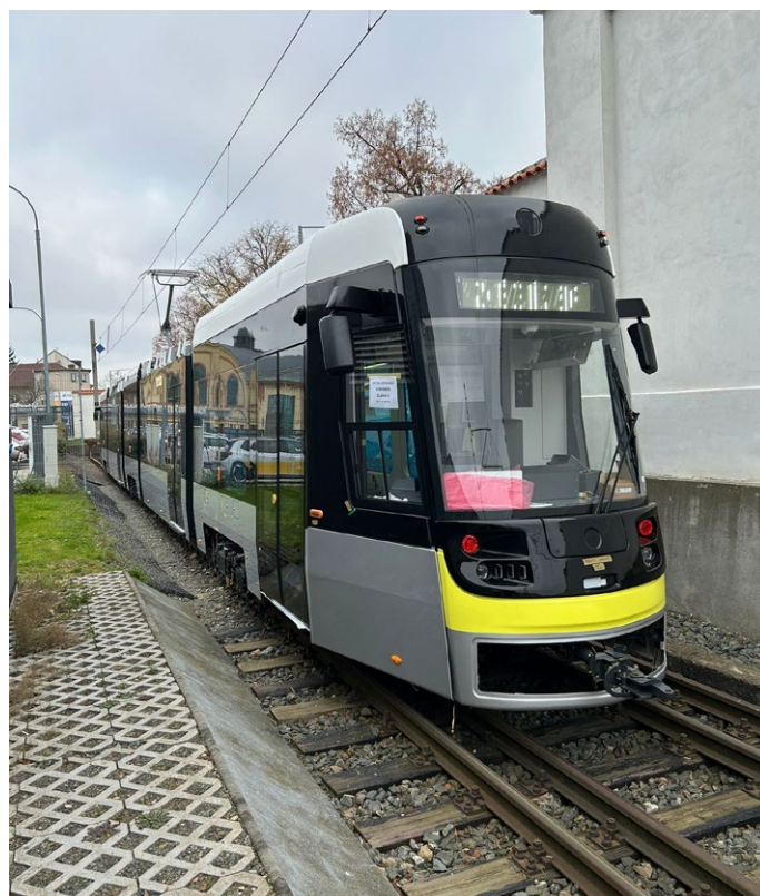
Il primo nuovo tram Škoda ForCity Classic da 33,5 m in livrea grigio-gialla posizionato sui binari del deposito di Petosino
